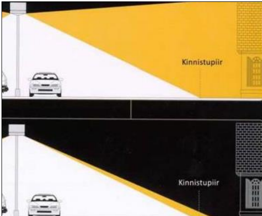
Joonis 4.6.3 Tee vale (ülemine pilt) ja korrektne (alumine pilt) valgustus. Allikas: Riigimaanteed valgustamise juhis. Maanteeamet, 2014
